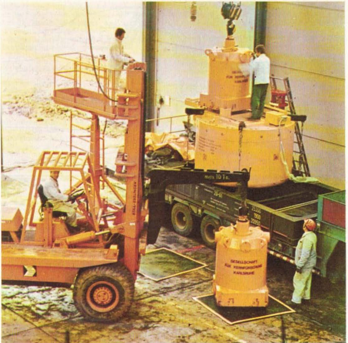
Abb. 125: Sammelabschirmbehälter 7 V für mittelradioaktive Abfallfässer — Gewicht: 25 bis max. 40 t
