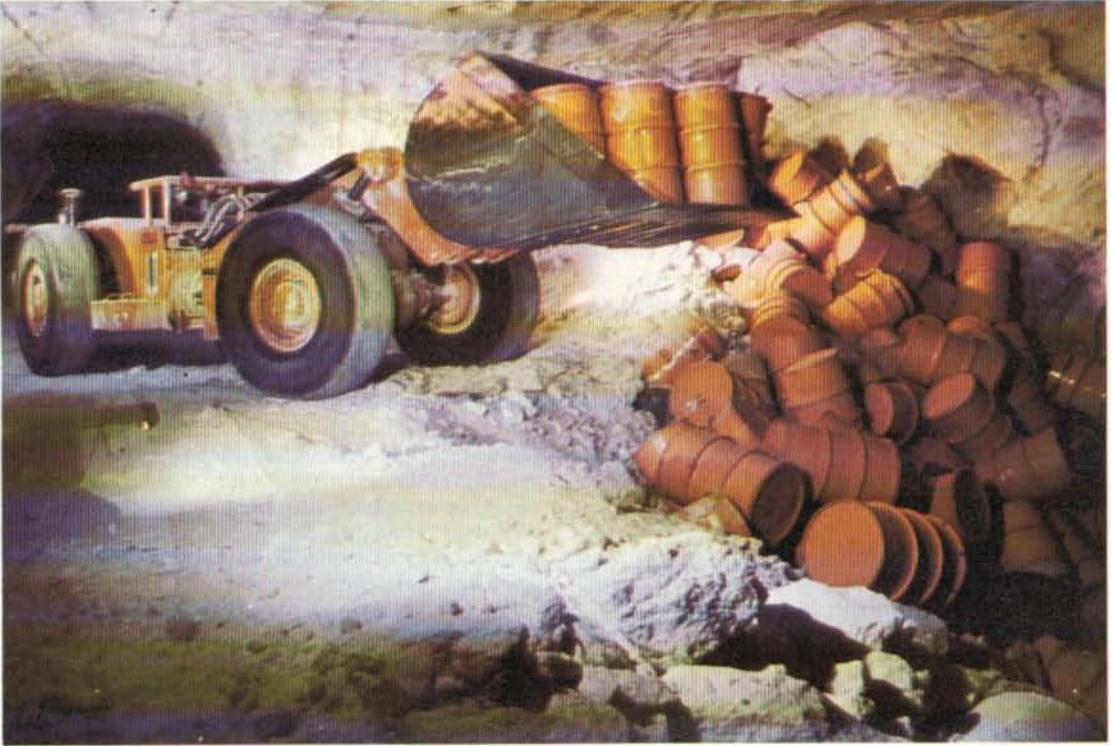
Abb. 120: Schaufelradlader Typ L 182 im Einsatz beim Einlagern von schwachradioaktiven Abfallstoffen
