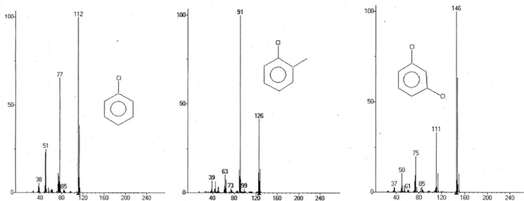
**Abb. 20:** Massenspektren halogener Aromaten, die bei Aufheizversuchen an Gorleben-Salz (RB 644H) mit einer BET-Oberfläche von 31,1 m<sup>2</sup>/g nachgewiesen wurden. Octan (5 µl bzw. 30,73 µmol) als Modell-Kohlenwasserstoff, Stickstoff-Atmosphäre, 75 µl Wasser, T = 315 °C, p = 105 bar, Reaktionsdauer 17 Tage.
